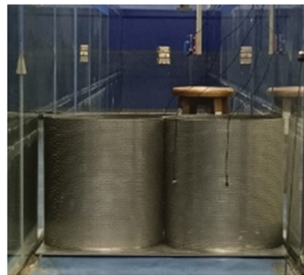
(d) Porous/impermeable circular pile model
